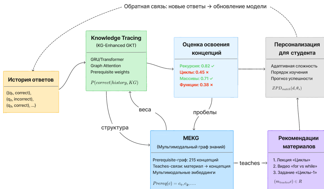
Рис. 6. Интеграция MEKG с системой Knowledge Tracing для диагностики знаний
